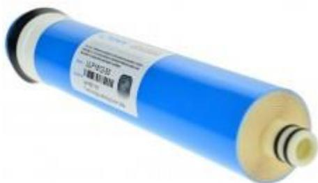
Особая полупроницаемая мембрана. Эта мембрана имеет поры, через которые проходят только молекулы воды. Вещества, растворенные в воде (различные примеси, соли тяжелых металлов), в силу большего размера своих молекул через мембрану проникнуть не могут. Мембрана обратного осмоса также препятствует прохождению различных органических веществ, а также вирусов и бактерий.
