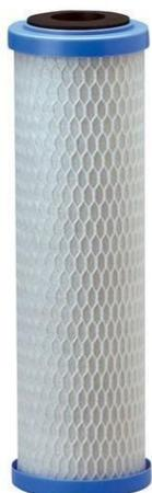
Угольный сменный картридж Pentek ЕРМ- используется для очистки воды от активного хлора, а также от механических частиц, что позволяет максимально сохранить ресурс активированного угля. Угольный прессованный блок защищен полипропиленовой оболочкой, что позволяет картриджу Pentek ЕРМ работать более года.
