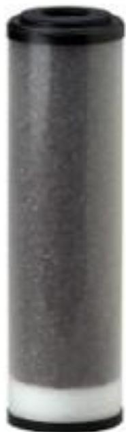
Картридж Pentek PCF1 предназначен для деионизации воды. Изготовлен с использованием специальной смолы состоящей из смеси катионита и анионита высокой чистоты. Применяется в качестве постфильтра в многоступенчатых системах очистки воды.
