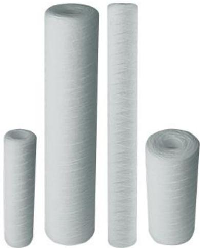
Картриджи серии РРУ предназначены для очистки воды от нерастворимых примесей. Изготовлены из полипропиленового шнура. Имеют самую большую грязеемкость из всех осадочных картриджей. Восстановлению не подлежит после окончания ресурса заменяется на новый.
