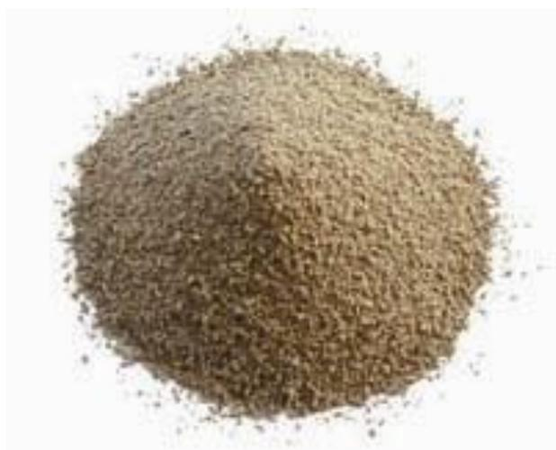
Фильтрующий материал для удаления железа и марганца из воды. **МЖФ** эффективно удаляет растворенные в воде железо с концентрацией до 50 мг/л и марганец с концентрацией до 2 мг/л. Область использования среды: от локальных бытовых систем очистки воды до муниципальных и промышленных станций водоподготовки. В многоступенчатых схемах фильтры с МЖФ стоят, как правило, в начале цепи, забирая на себя основной объем загрязнений. Цвет: коричнево-бурый. Фасовка 18кг. Фракция 0,5-1,5мм. Плотность 2,5г/мл.
