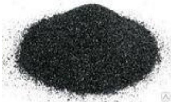
**VLCL012x40** Гранулированный активированный уголь предназначен для удаления запахов, снижения содержания растворенных органических веществ и цветности в воде. Гранулы активированного угля, полученные из скорлупы кокосового ореха, обладают высокой плотностью и прочностью на механическое и динамическое истирание. Цвет гранул: чёрный. Фасовка 50л. 1л-5кг. Фракция 1-3мм
