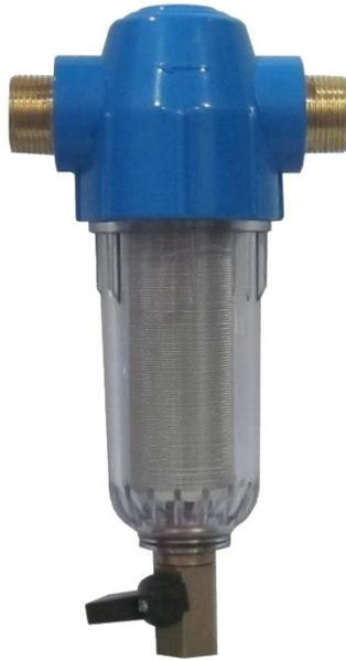
Фильтр Гейзер Хит 3/4" 100 мкм (грязевик) применяется для удаления из воды твердых взвешенных частиц (ржавчина, песок, ил и другие нерастворимые примеси) более 100 мкм. Улучшает показатели мутности и цветности воды.
